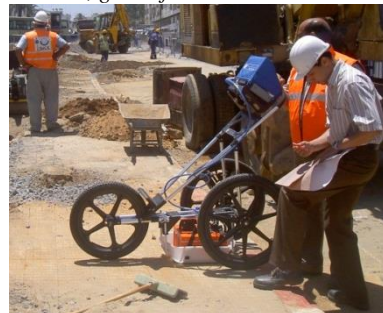
Détection, géo-référencement des réseaux
